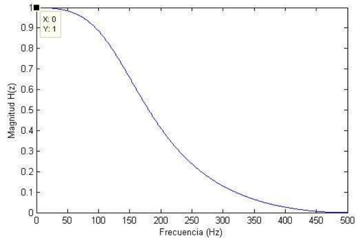
Figura 4: Respuesta en frecuencia con factor de corrección de ganancia
