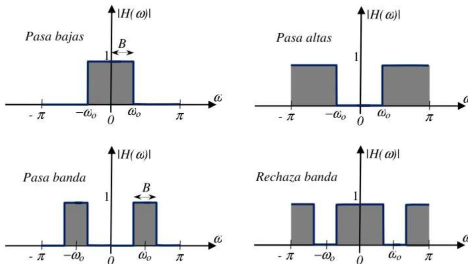
Figura 1 Módulos ideales de respuestas en frecuencia de los 4 tipos de filtros básicos.
