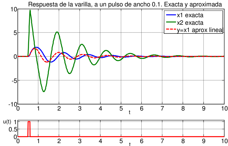
Figura 6.7.- Respuesta de la varilla a un pulso de ancho 0.1 y amplitud 1, calculada mediante el modelo no lineal exacto (6.7) y el modelo lineal aproximado (6.19).
