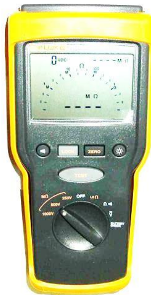
Figura 2.- Megóhmetro FLUKE® disponible en el laboratorio.
