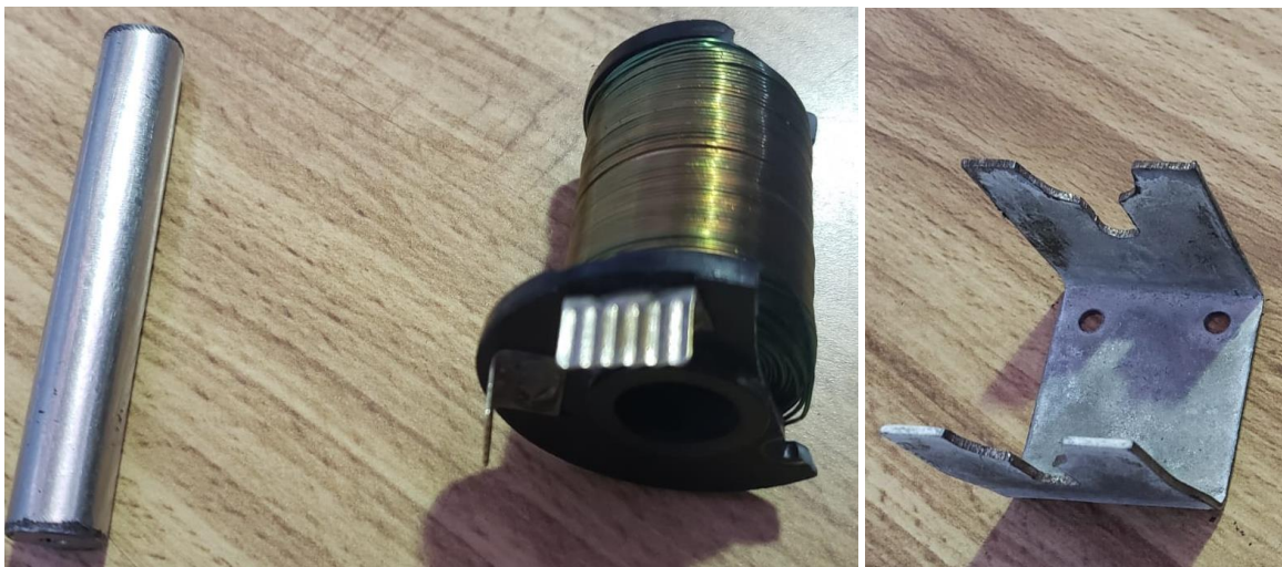
Figura 3. Bobina pequeña alimentada a 6 vcd y su núcleo de hierro, así como su base de montaje.
