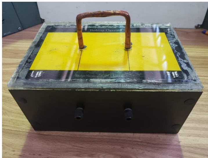
Figura 2. Bobina de Oersted alimentada con 1v y 1A.
