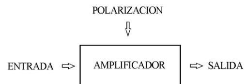
La polarización de c.d. del amplificador es muy importante para que este funcione adecuadamente. La entrada es una señal de voltaje o corriente (o ambas) y se considera como un estímulo. La respuesta es una señal de voltaje o corriente (o ambas) y también será la salida del amplificador.
