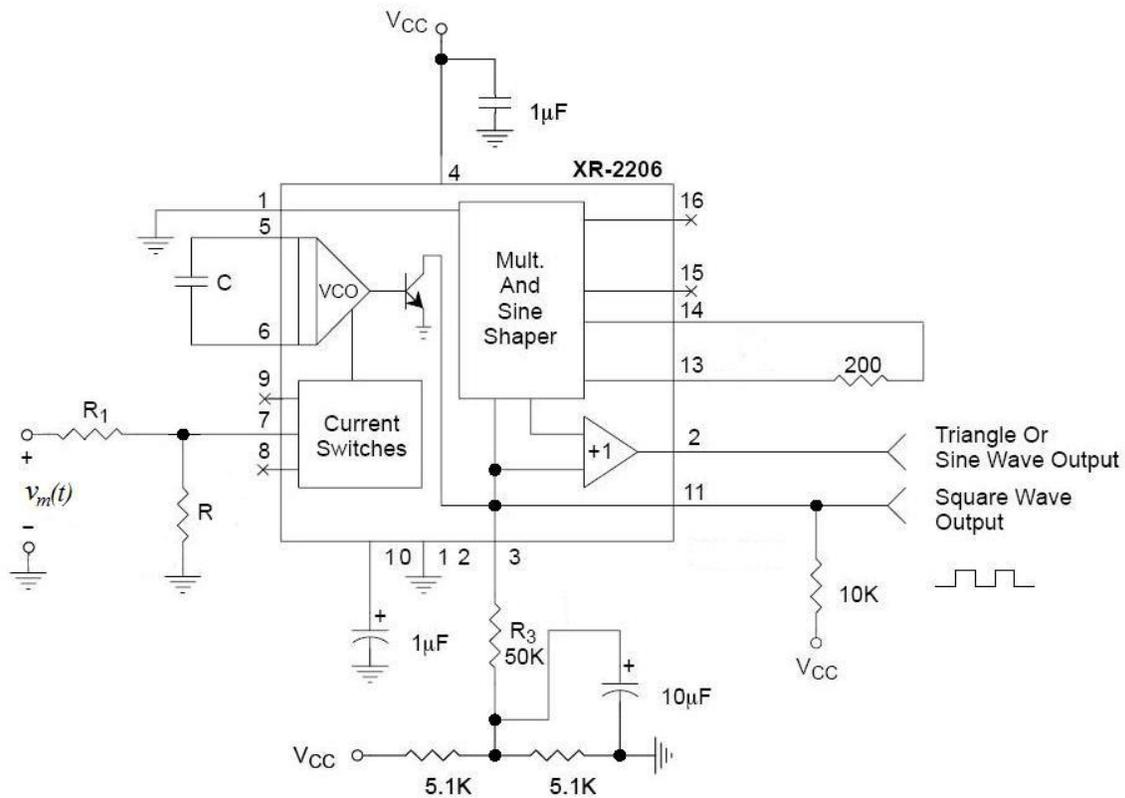
**Establecimiento de la frecuencia de oscilación:** Como el circuito produce una señal modulada en frecuencia, la frecuencia de la señal de salida es variable y es controlada por el arreglo de resistencias conectado a la patita 7 u 8, el cual se muestra nuevamente a continuación con mayor detalle:
