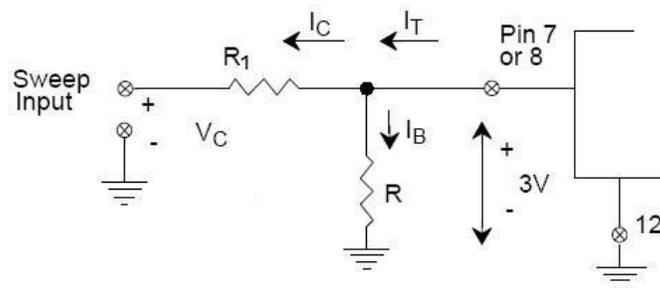
El circuito se encarga internamente de mantener un voltaje de 3 v en la patita 7 u 8, y el usuario se encargará de introducir el voltaje modulante  $v_m(t)$  en  $V_c$  (sweep input).
