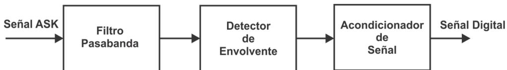
Figura 2: Diagrama a bloques de un demodulador ASK.
