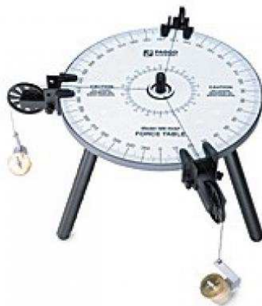
Fig. 2 Disposición experimental de los pesos en la mesa de fuerzas.
