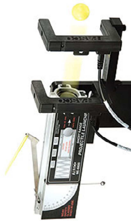
Figura 1. Lanzador colocado verticalmente con dos fotopuertas acopladas.
