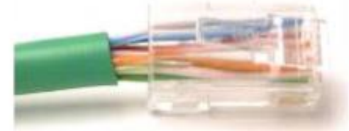
Cable UTP mal terminado
