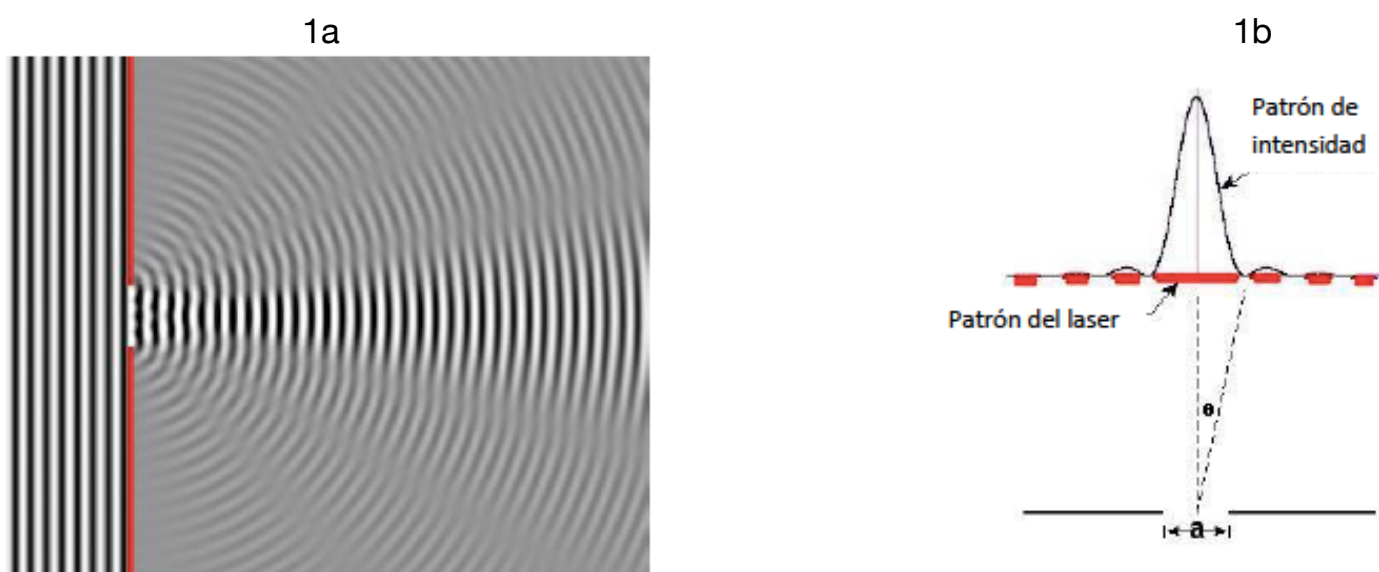
Figura 1a. Difracción de una onda al pasar por una rendija delgada.
